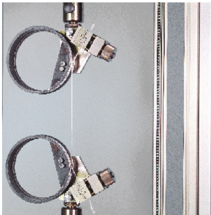
Obr. 15: Čelisti se šroubovým systémem upnutí pro zkoušku tahem drátů
