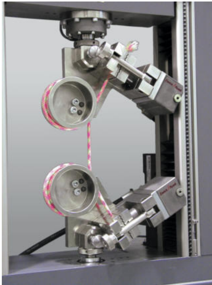
Obr. 14: Čelisti s hydraulicko-mechanickým systémem upnutí pro zkoušku tahem drátů
