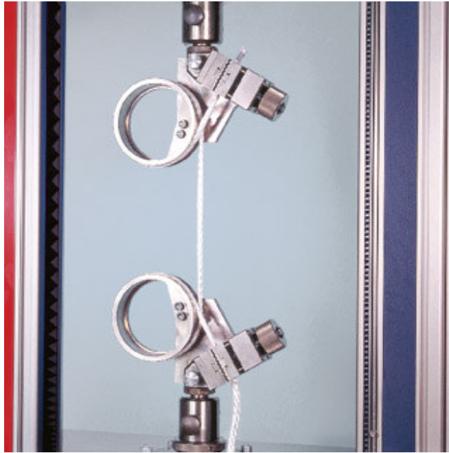
Obr. 16: Čelisti se šroubovým systémem upnutí pro zkoušku tahem drátů
