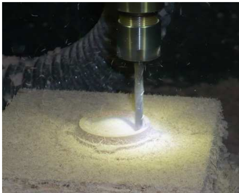
Obr. 23 Výroba modelů na 3D CNC frézce
