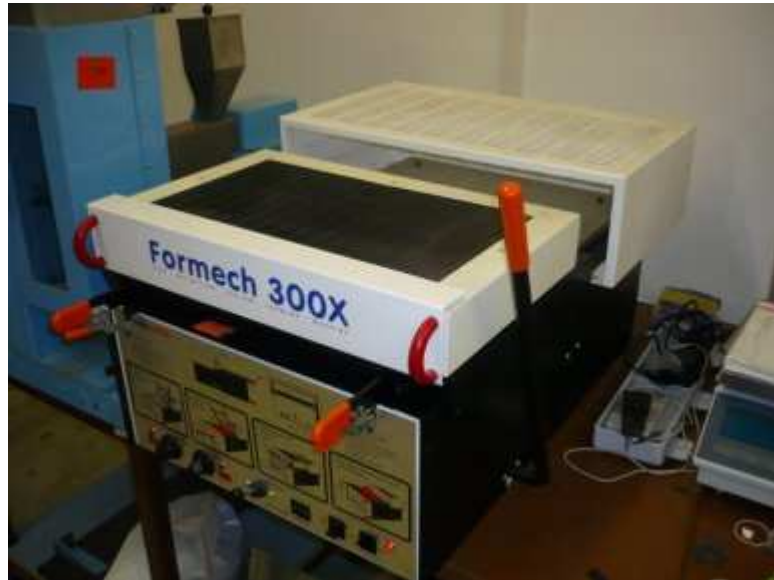
Obr. 19 Vakuovací stroj Formech 300X
