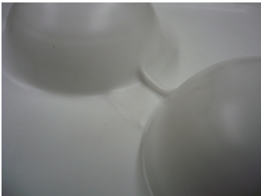
Obr. 30 Vznik přeloženin vlivem nedodržení technologických vzdáleností
