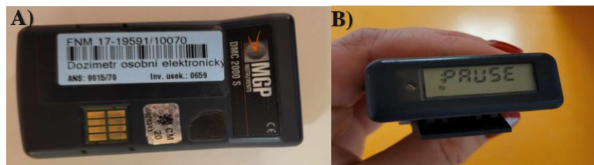
Obr. 15 Osobní elektronický dozimetr (A) Pohled na zadní stranu dozimetru; B) Elektronický displej poskytující aktuální informaci o dávce)
