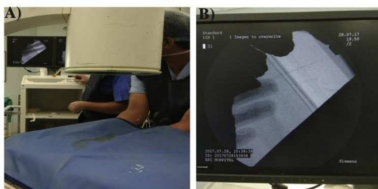
Obr. 10 Kontrola ochranné zástěry pomocí rentgenového přístroje (A) Zesilovač C-ramene během kontroly ochranné zástěry; (B) Rentgenový snímek ochranné zástěry)
