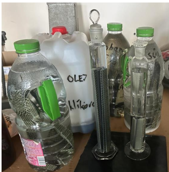
Obrázek 17 Na pravo ve předu Incidin Rapid, za ním motorový olej, za olejem bacoban, na levo kyselina sírová a za ní roztok soli
