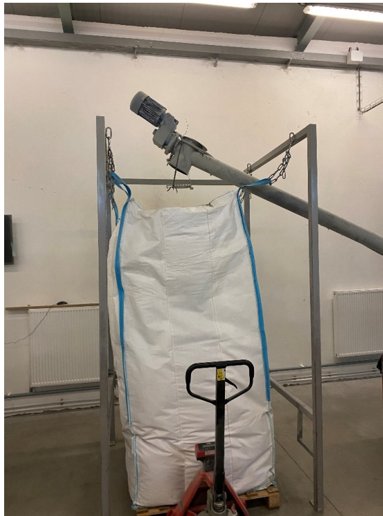
Obrázek 11 Přepravní vak Big Bag se zakončením šnekového potrubního dopravníku s magnetickým sítem (zdroj: vlastní)
