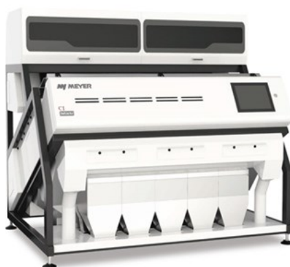
Obrázek 22 Multifunkční třídička dle barevného spektra a typu polymeru (HEFEI MEYER OPTOELECTRONIC TECHNOLOGY INC., c2001-2020)
