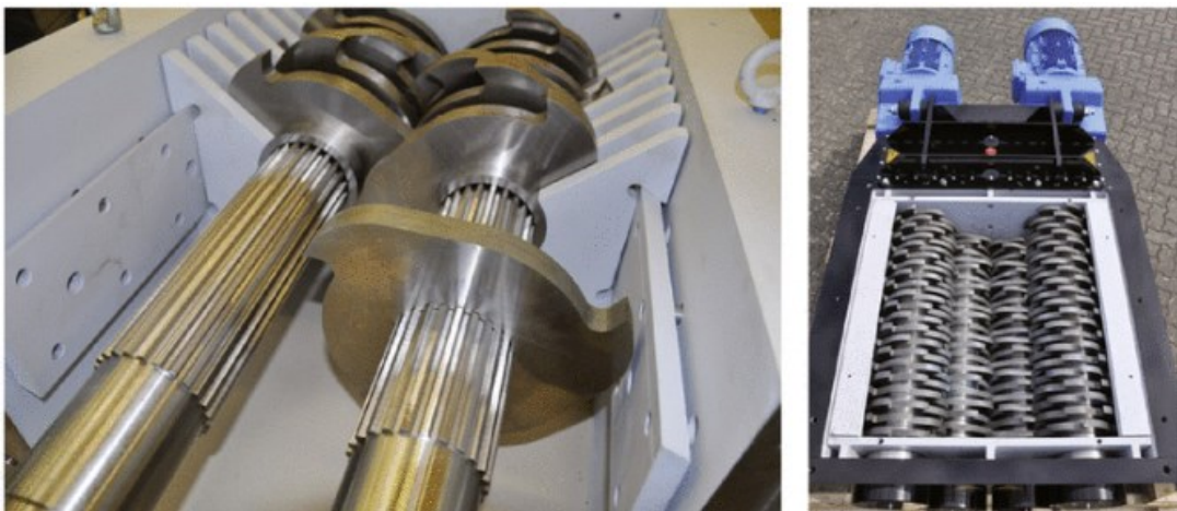
Obrázek 1 Sestava hřídelové rotační drtičky (Niessner, 2022)
