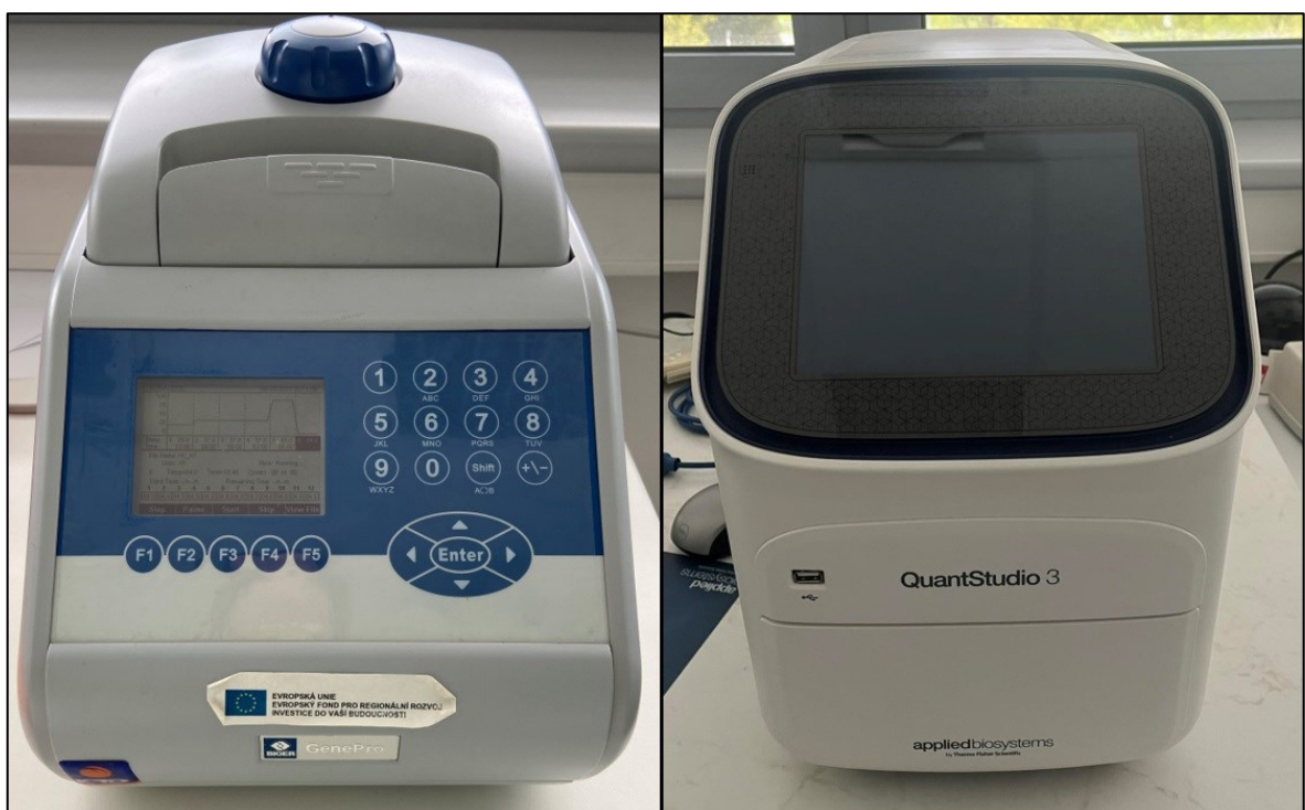
Obrázek 14 Přístroje používané pro reverzní transkripci a qRT-PCR (vlevo termocykler Biometra TOne 96 G, vpravo přístroj QuantStudio 3)
