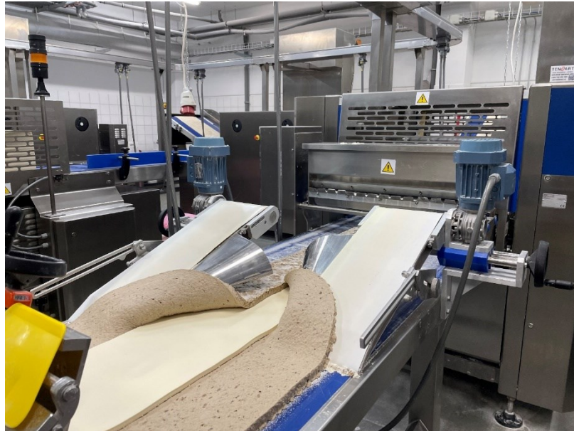
Obrázek 30 Uzavírání tuku do těsta (vlastní zpracování)
