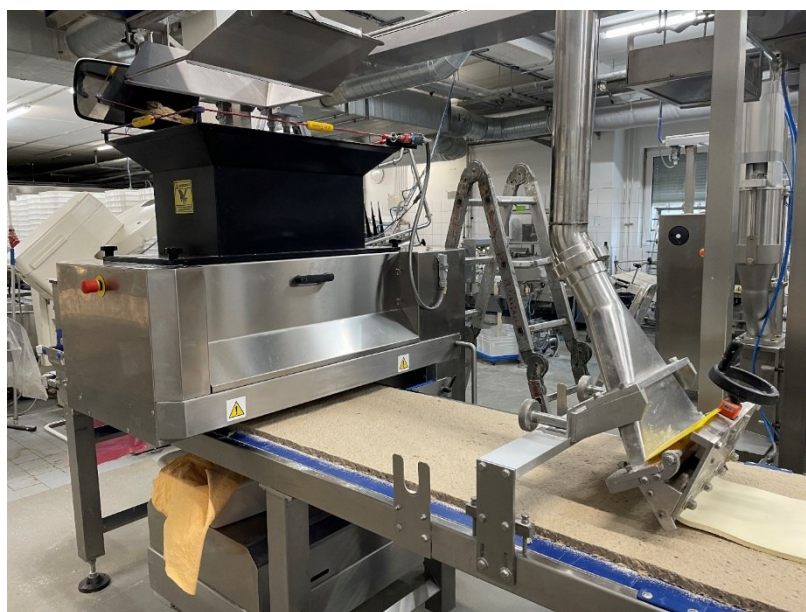
Obrázek 29 Dávkování těsta a nanášení tuku (vlastní zpracování)
