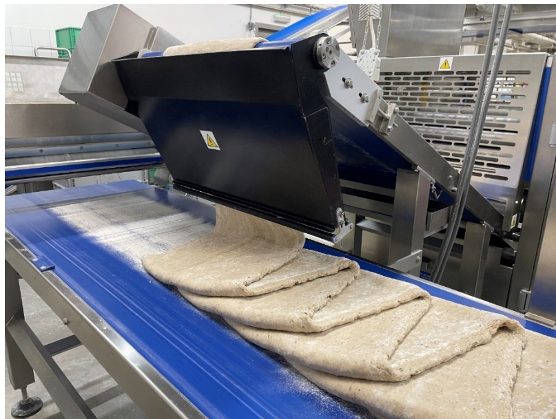
Obrázek 19 Překládání těsta (vlastní zpracování)
