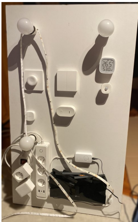
Obrázek 7 Lepení součástek na desku tavným lepidlem
