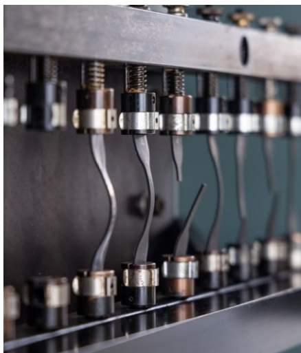
Obrázek 4 – Testovací vzorek a zařízení FTF [24]
