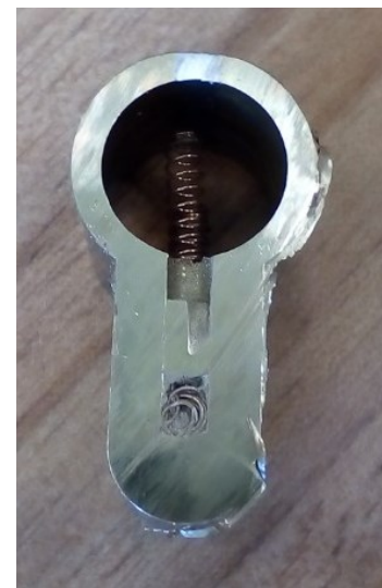
Obr.5 Stavítka, blokovacie kolíky a pružiny [Vlastný zdroj]
