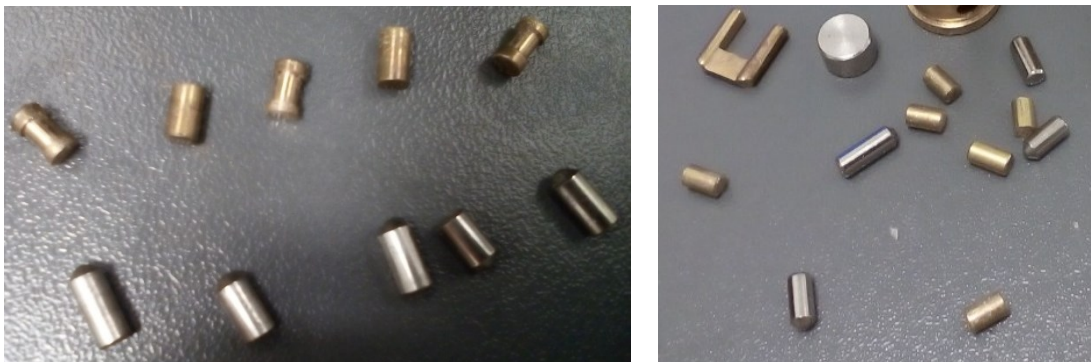
Obr.4 Rôzne tvary blokovacích kolíkov [Vlastný zdroj]
