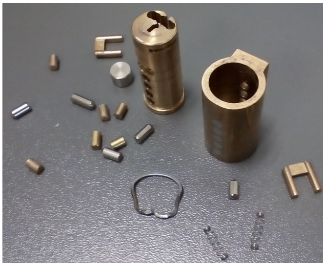
Obr.5 Stavítka, blokovacie kolíky a pružiny [Vlastný zdroj]
