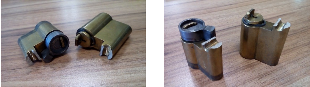
Obr.11 Rozlomenie cylindrickej vložky [Vlastný zdroj]
