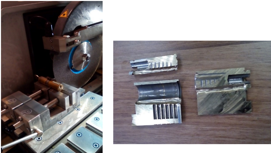
Obr.28 Priechny rez na zariadenie Mecatome T210 značky Presi (vľavo) a pozdĺžny rez cylindrickej vložky (vpravo) [Vlastný zdroj]
