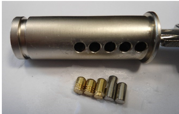
Obr.20 Ochranné prvky z tvrdokovových materiálů – stavítka [Vlastný zdroj]
