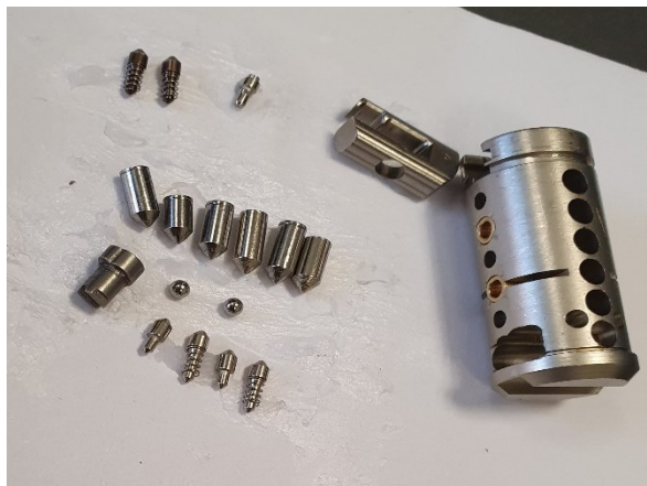
Obr.21 Ochranné prvky proti odvrátání [Vlastný zdroj]
