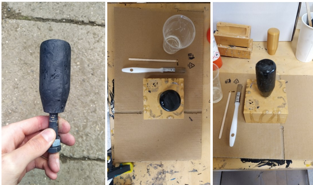
Obrázek 43a) Řadička obroušená od otřepů b) Nanášení čirého epoxidu c) Tuhnutí epoxidu
