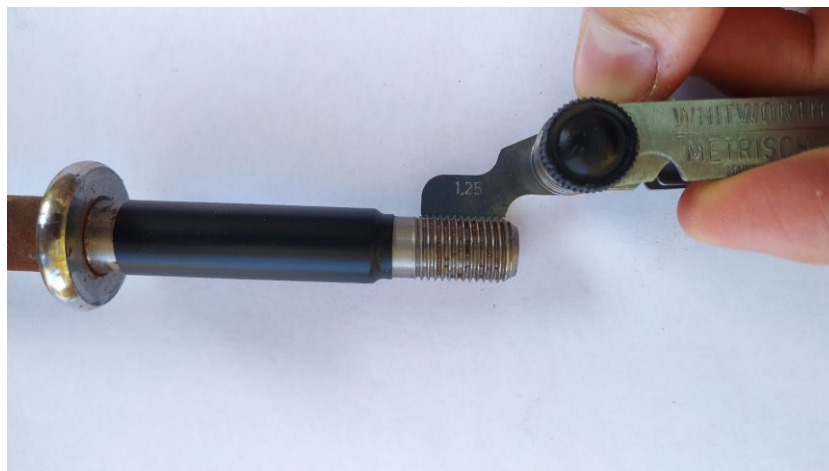
Obrázek 35 Měření stoupání závitu pomocí měrky závitů
