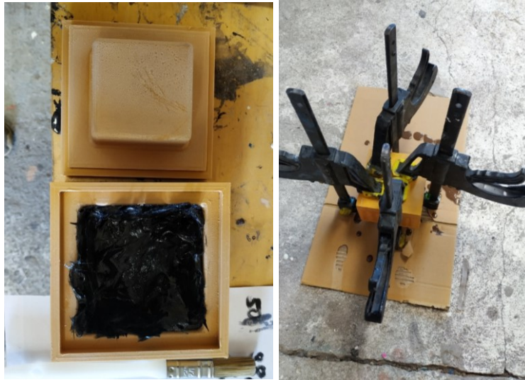
Obrázek 31a) Naplnění formy, mix epoxid – drcené uhlíkové vlákno (levý)
