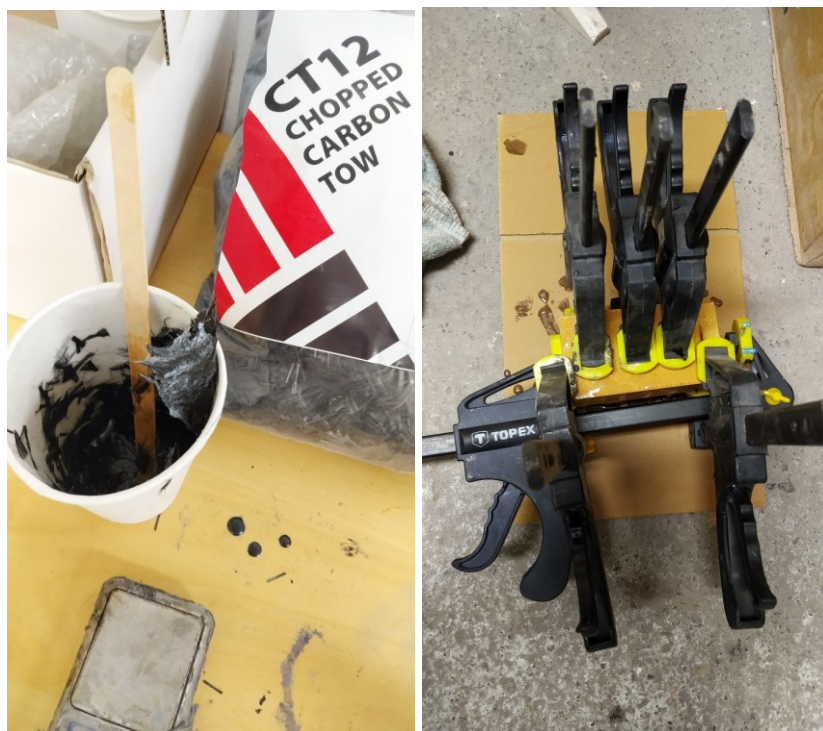
Obrázek 41a) Mixování epoxidu a uhlíkového vlákna b) Sevržení formy svorkami
