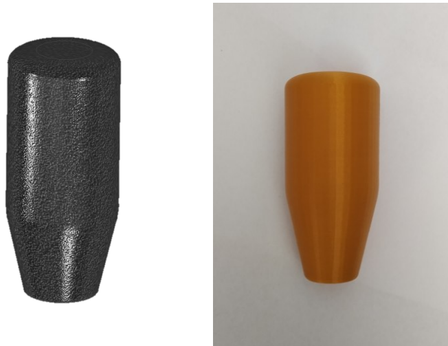
Obrázek 37a) 3D model řadičky b) Vytisknutá maketa řadičky
