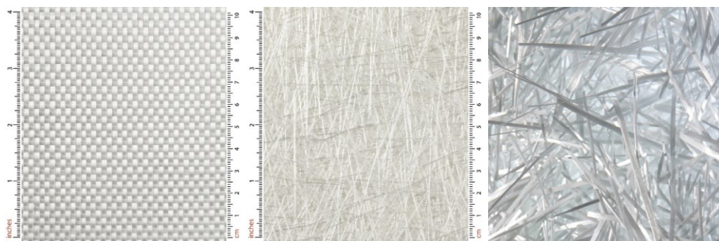
Obr.18a) Spředený roving b) Skelná rohož c) Krátká skelná vlákna [11] [12]
