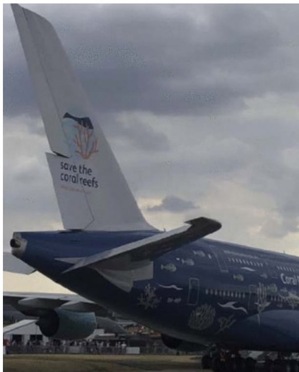
Obrázek 26 Celokompozitová ocasní sestava letounu Airbus A380 s korunou trupu [16]
