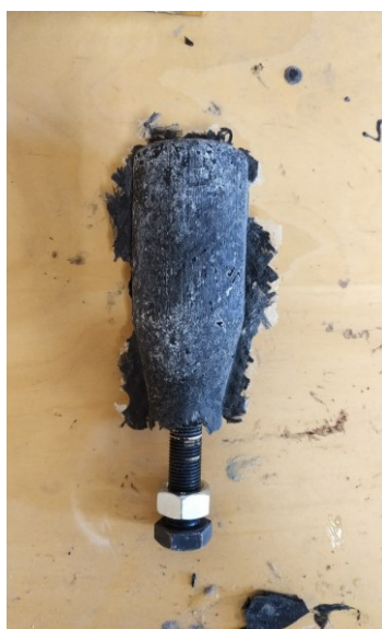
Obrázek 42- Řadička ihned po vyjmutí z formy
