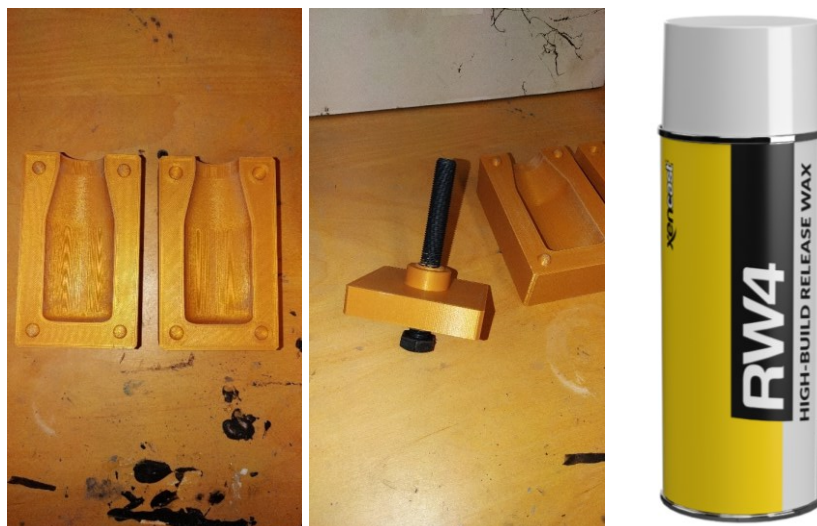
Obrázek 40a) Navoskované části formy b) Navoskovaný závit c) Použitý separační vosk
