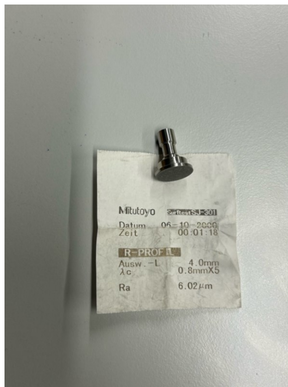
Obrázok 17 - geometria použitá na reologické testy
