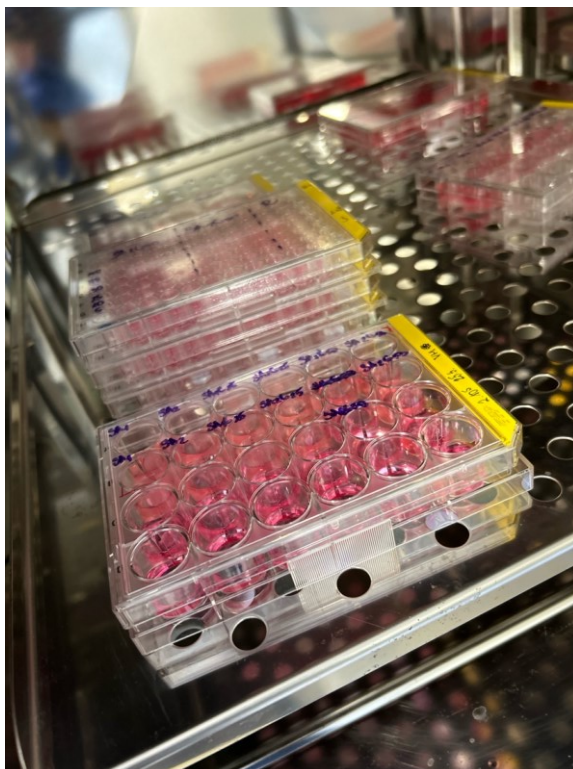
Obrázok 11 - plát obsahujúci suspenziu buniek a hydrogél využitý na test cytotoxicity v priamom kontakte
