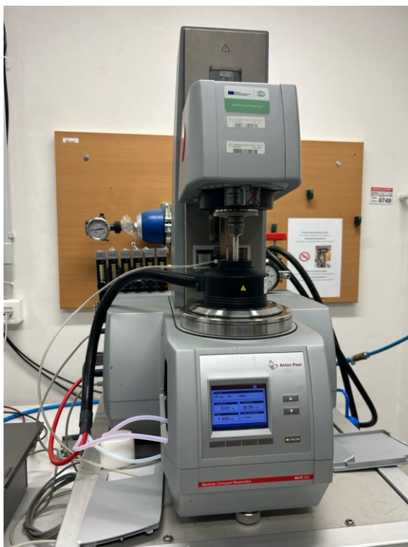
Obrázok 16 - reometer Anton Paar
