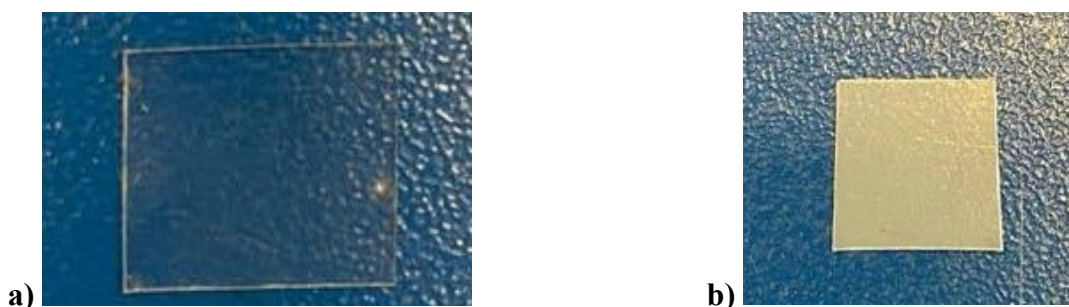
Obrázek č. 11: Dílčí vzorky vložené do burial testů a) PLA b) PLA/EGMA
