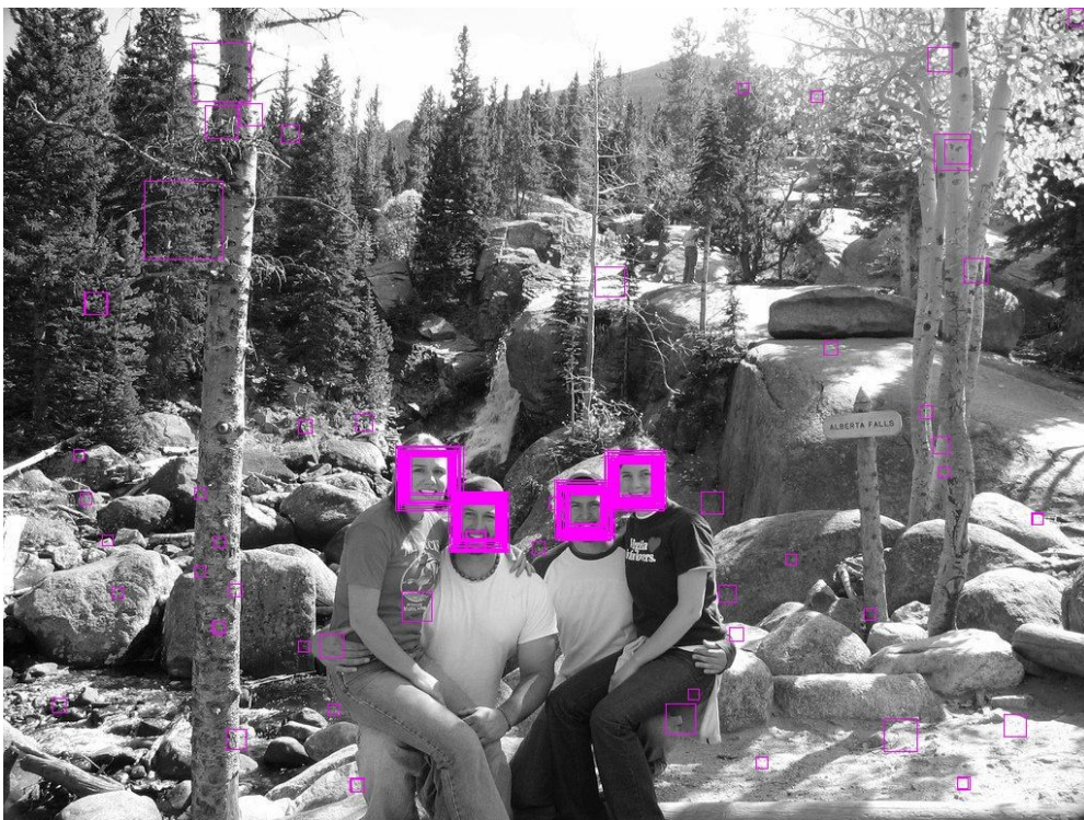
Obrázek 15. Falešná detekce způsobená malou hodnotou minNeighbors [31]
