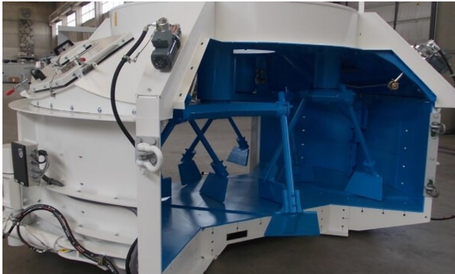
Obrázek 6: Planetová míchačka v řezu (Xentrix, ©2024)
