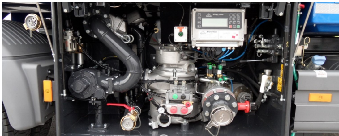
Obrázek 8 - Technologický prostor nástavby CN – 8 (Cisternové nástavby a přívěsy, 2024)
