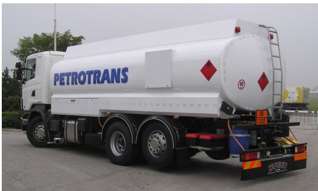
Obrázek 7 - Cisternová nástavba CN 20 (Cisternové nástavby a přívěsy, 2024)
