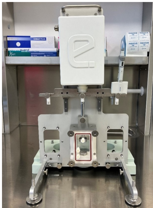
Obrázek 6. Mechanický bioreaktor TC-3 (EBERS Medical Technology). Zdroj: archiv autorky.
