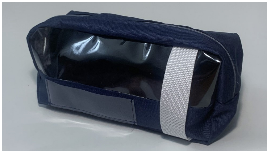
Obrázek 46 Zkouška – nevhovující tvarové řešení průhledu
