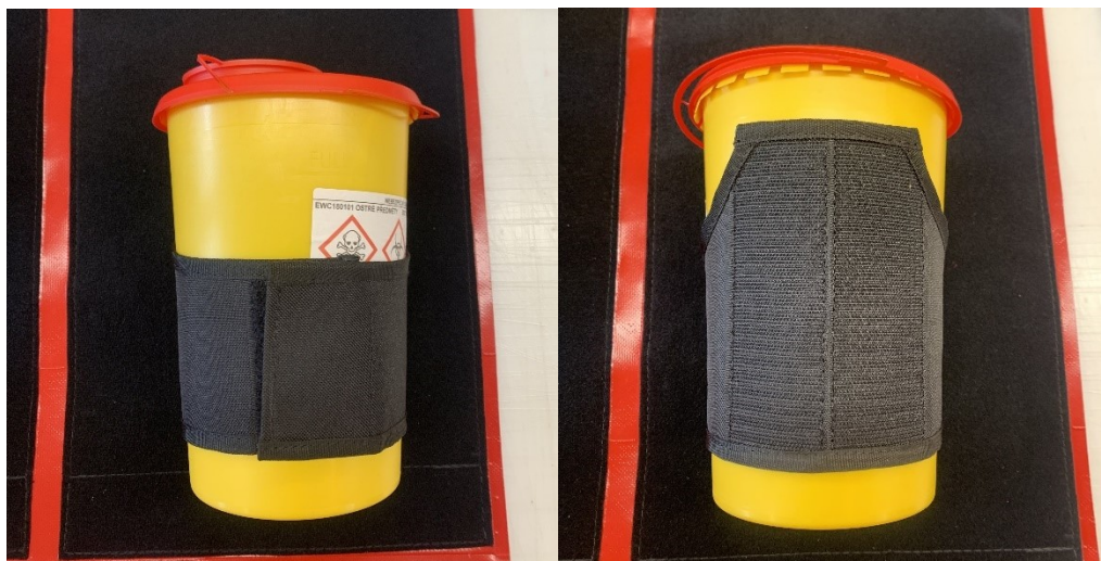
Obrázek 59 Šitá zkouška závěsu na kontejner
