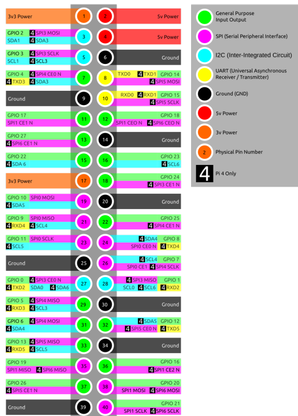
Obrázok 2 40-Pinový header na Raspberry Pi[13]
