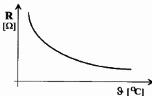
Obrázek 4. Negastor – závislost odporu na teplotě [9]
