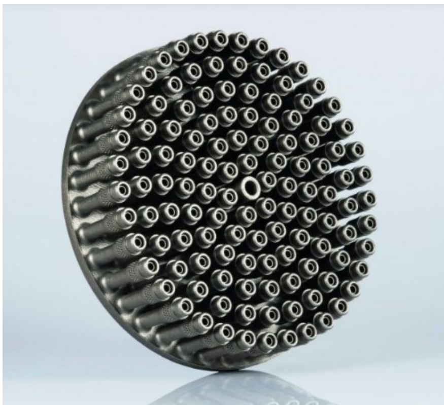
Obrázek 10. 3D vytištěná injektorová hlava pro odpalovací zařízení [24].
