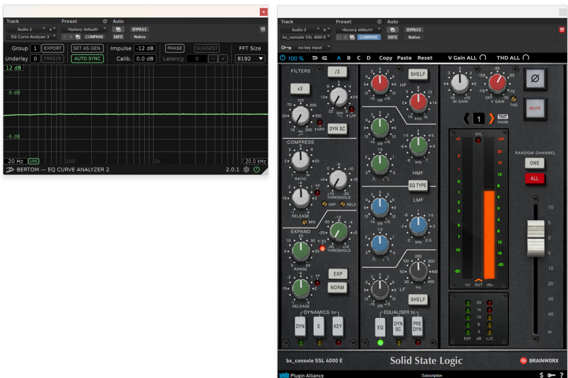
Obrázek 35: frekvenční odezva SSL 4000E při vypnutí jednotlivých filtrů
