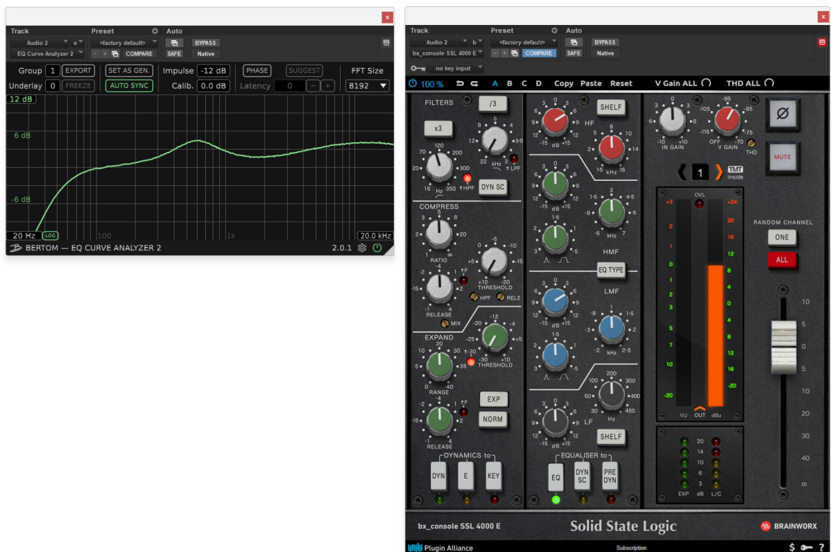
Obrázek 30: zobrazení reálné frekvenční odezvy při zadání parametrů u ekvalizéru SSL 4000E
