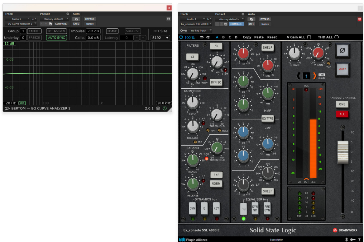
Obrázek 37: frekvenční odezva SSL 4000 E při vypnutí jednotlivých filtrů a minimálních hodnotách V Gain a THD
