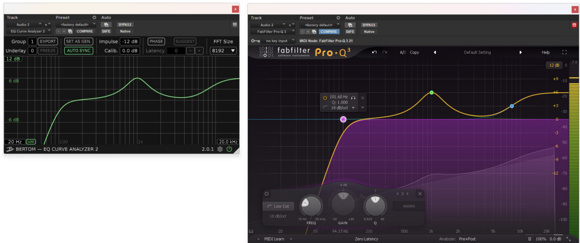
Obrázek 28: zobrazení reálné frekvenční odezvy při zadání parametrů u ekvalizéru Pro-Q 3
