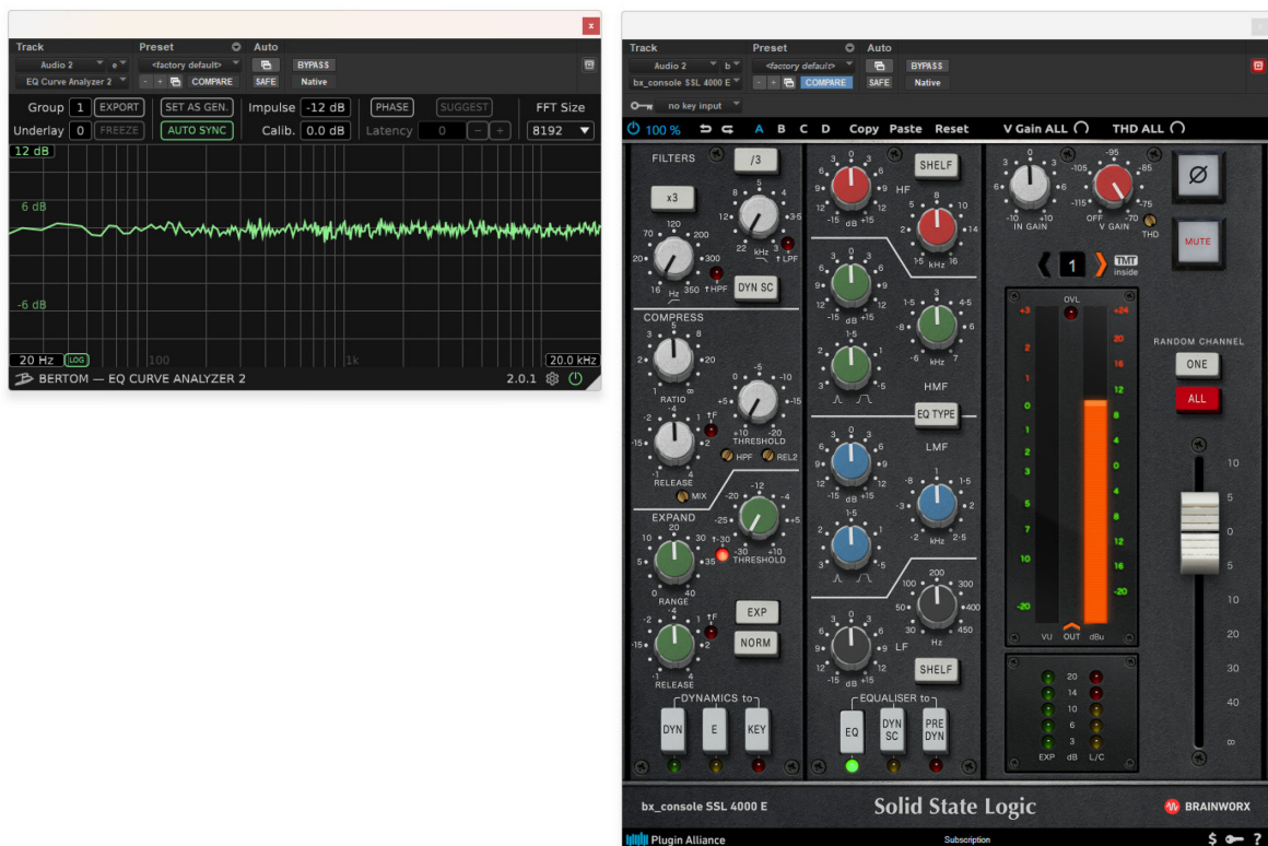
Obrázek 36: frekvenční odezva SSL 4000 E při vypnutí jednotlivých filtrů a maximálních hodnotách V Gain a THD
