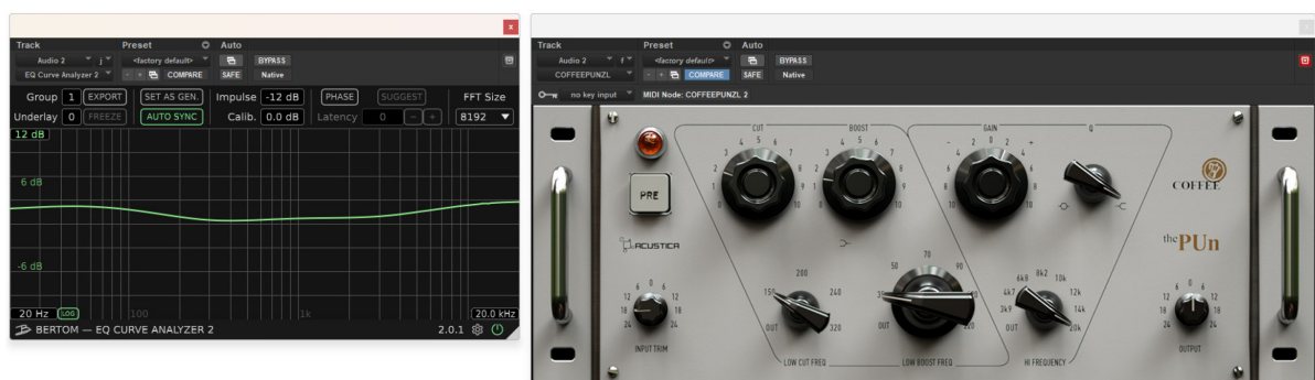
Obrázek 31: frekvenční odezva ekvalizéru Coffee The Pun po zadání parametrů
