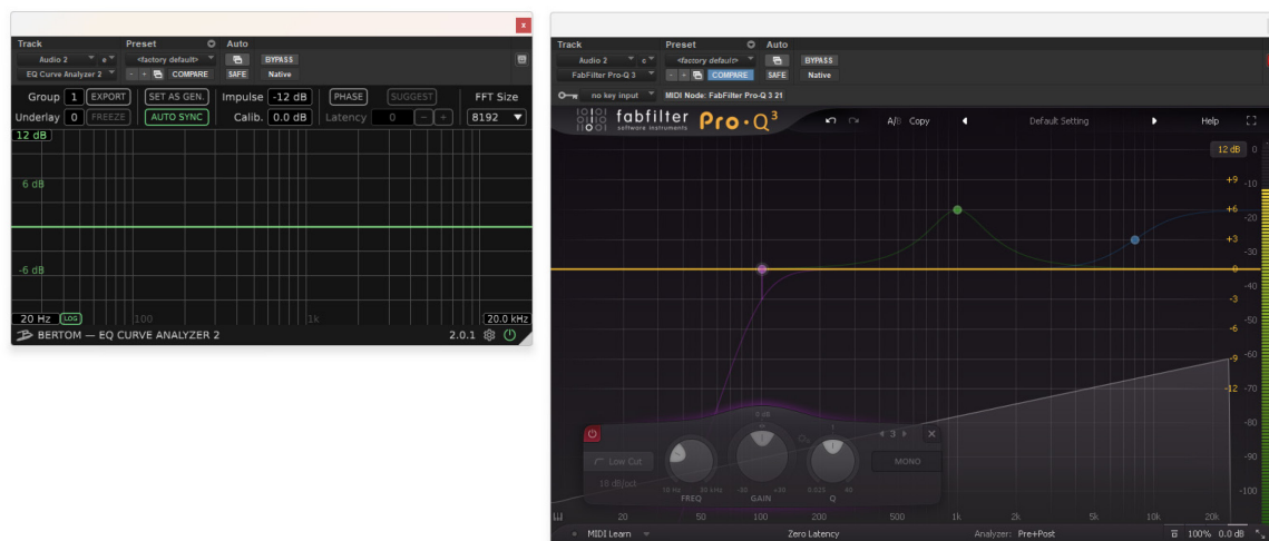
Obrázek 33: frekvenční odezva FabFilter Pro-Q 3 při vypnutí jednotlivých filtrů
