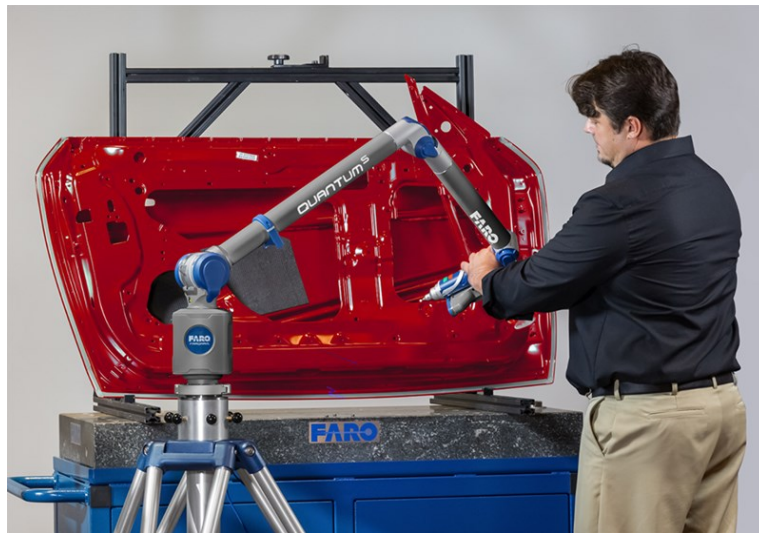
Obrázek 5 kontaktní skenování robotickým ramenem (Filament2Print, 2021)
