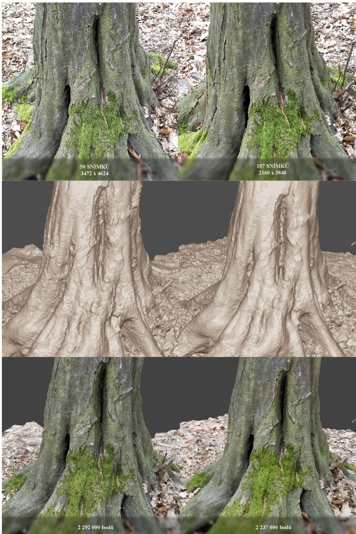
Obrázek 27 srovnání skenů z fotografií a videozáznamu
