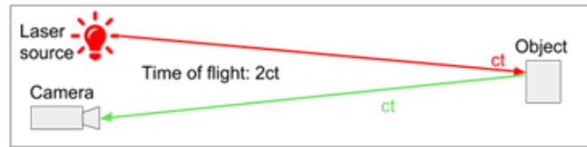
Obrázek 2 čas odrazu laserového paprsku (Bitfab, 2024)
