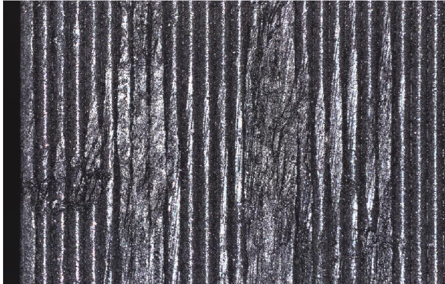
Obrázek 43 PLA po reálném provozu
