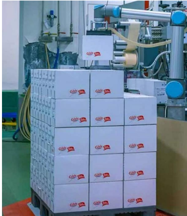
Obrázek 13 využití vakuového robota ve výrobě [19]
