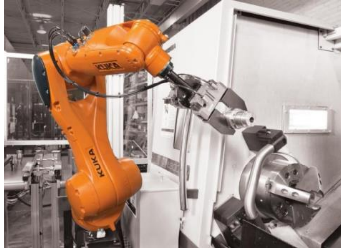
Obrázek 11 manipulační robot u cnc stroje [6]
