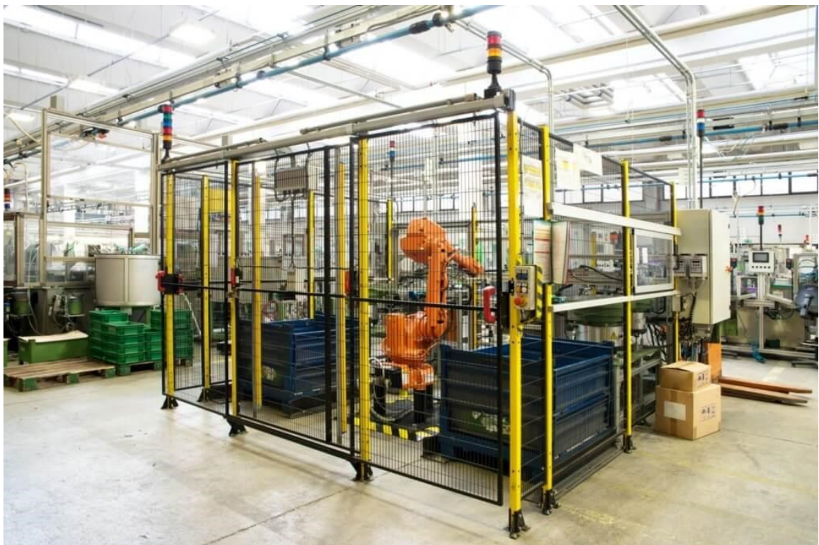
Obrázek 7: Ukázka ochranného oplocení robotického pracoviště (Beneš, 2021)
