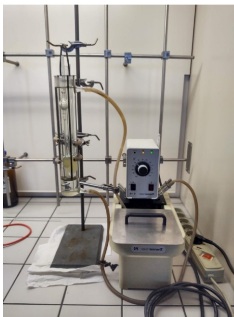
Obrázek 11; Aparatura pro stanovení viskozity
