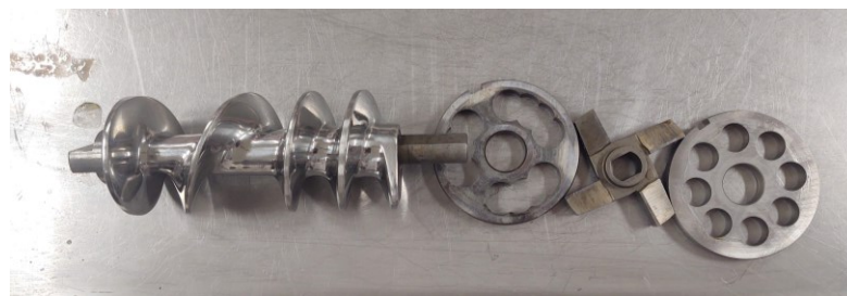
Obrázek 7; Vnitřní část mlýnku použitá k homogenizaci rybího materiálu.
