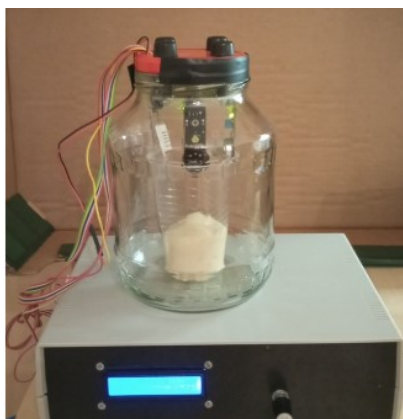
Obrázek 7 Experimentální elektronický nos [vlastní zdroj]
