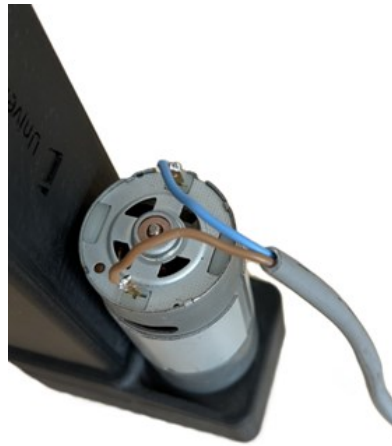
Obrázek 40. Kabeláž pro napájení motoru
