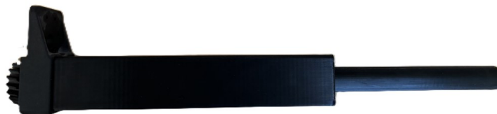
Obrázek 36. Našroubování pístu na závitovou tyč a kolejnici
