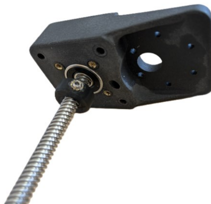
Obrázek 31. Vložení ložisek, závitové tyče a matice do základny
