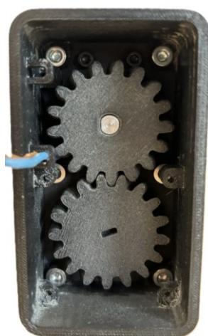
Obrázek 39. Ukázka upevnění ozubených kol a krytu
