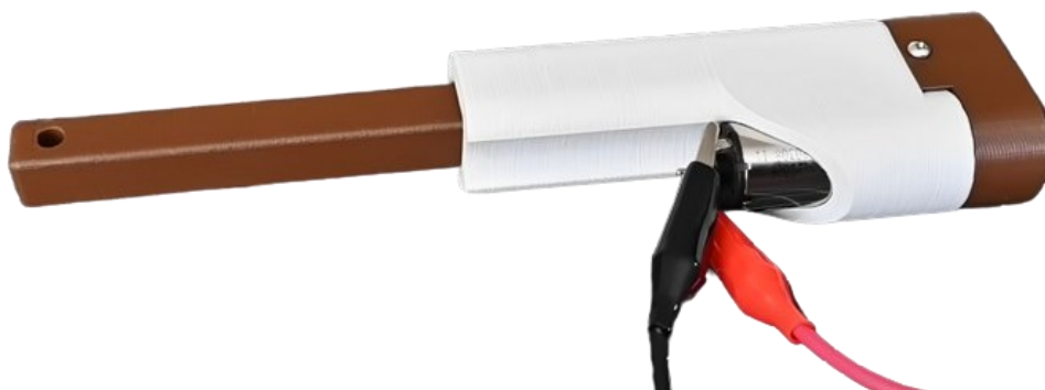
Obrázek 17. Aktuátor z dílů vyrobených pomocí aditivních technologií [40]
