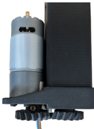
Obrázek 38. Upevnění motoru a hnacího kola
