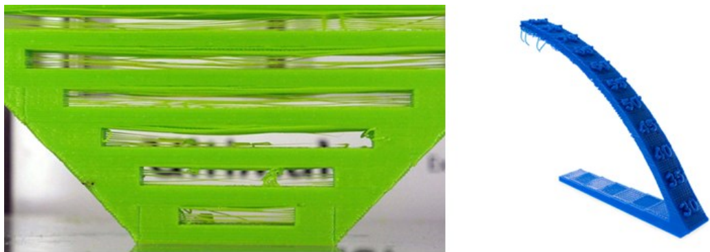
Obrázek 11. Narušená stabilita vrstev z důvodu nedostatečné podpory [25; 27]
