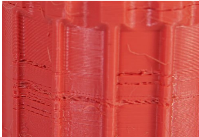
Obrázek 14. Ukázka strukturálního poškození produktu [26]
