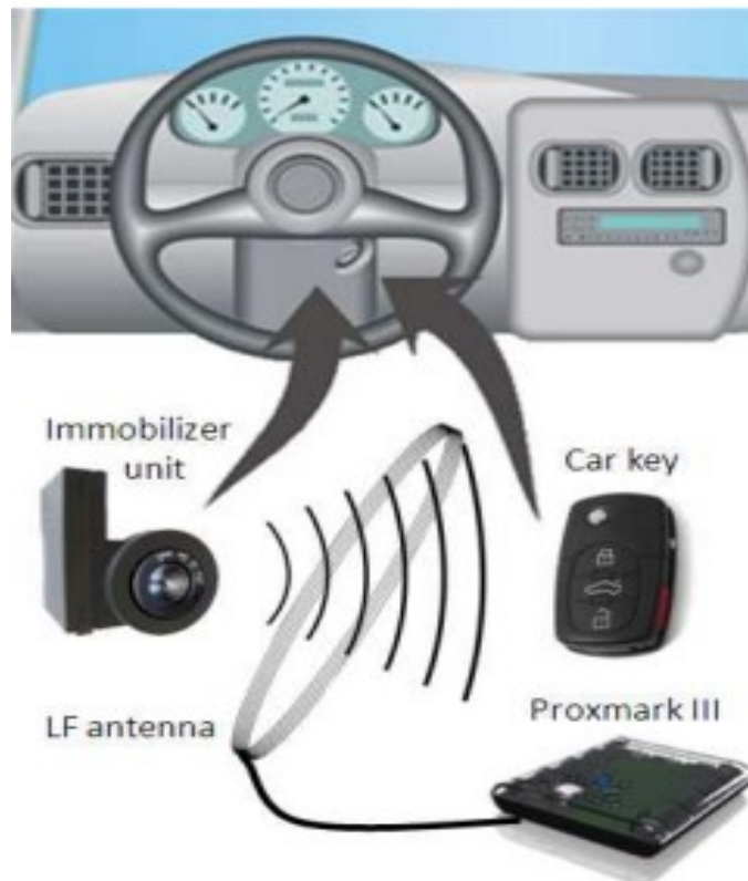
Obrázok 5 Útok pomocou Proxmark III [4]
