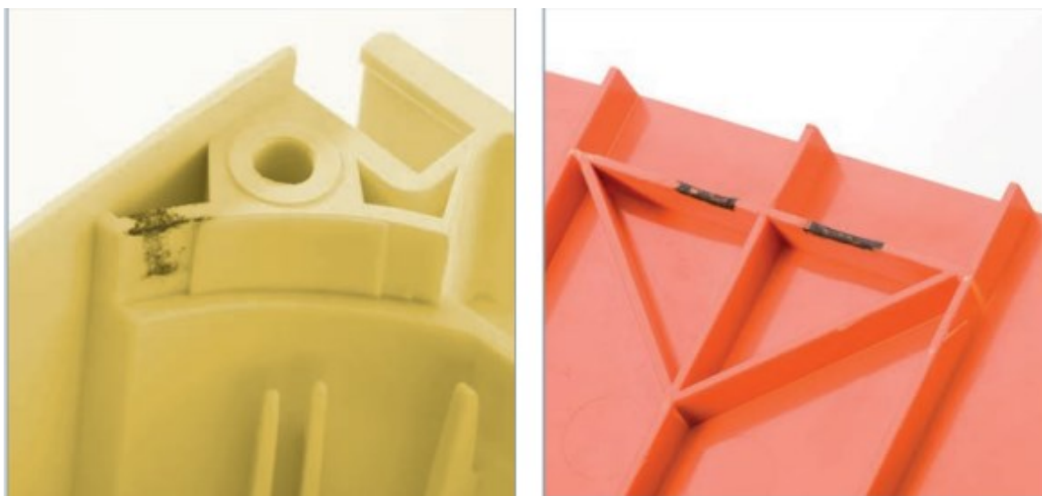
Obrázek 16 Dieselův efekt [33]
