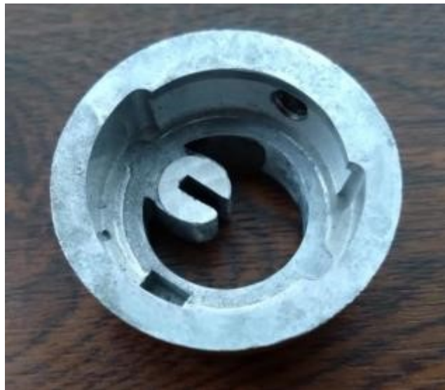
Obrázek 45 Upravená objímka s vyfrézovanou drážkou
