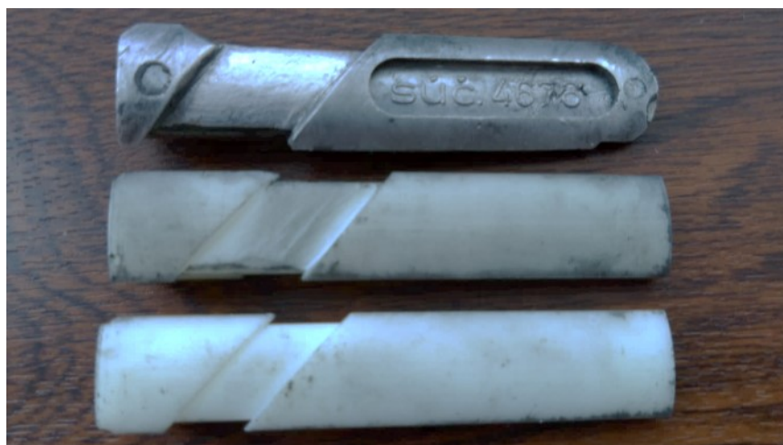
Obrázek 31 Srovnání šířky drážky na originálním jezdcí a 3D výtiscích
