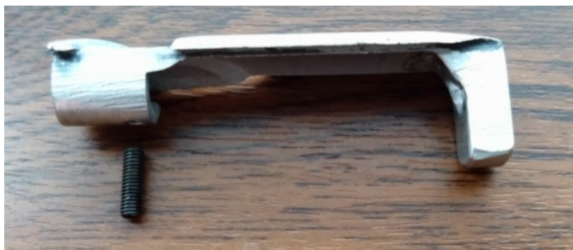
Obrázek 43 Vyrobený upravený jezdec se stavěcím šroubem M3
