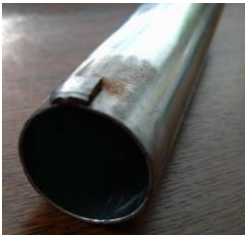
Obrázek 47 Plech sloužící jako záložka navařený na rukojeť
