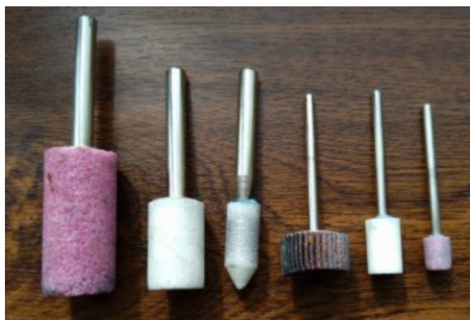
Obrázek 49 Brusné kotouče a válečky použité k odstranění nedostatků
