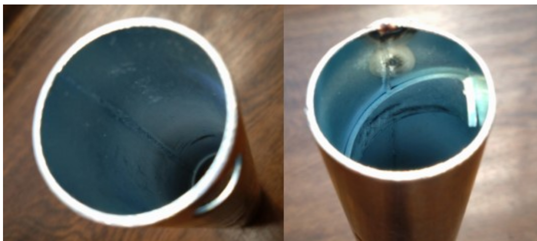
Obrázek 48 Šev uvnitř trubky před jeho odstraněním
