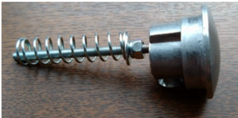
Obrázek 52 Celek záslepky s vlepeným insertem a závitovou tyčí
