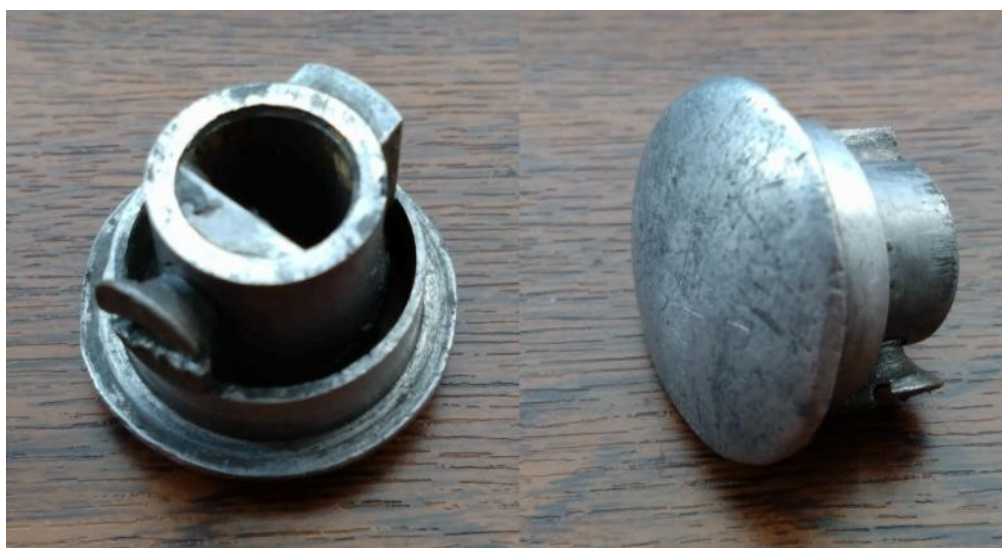
Obrázek 25 Originální záslepka se šroubem M6
