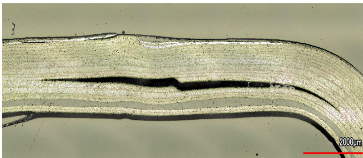
Obrázek 12 – delaminace vzorku č.2
