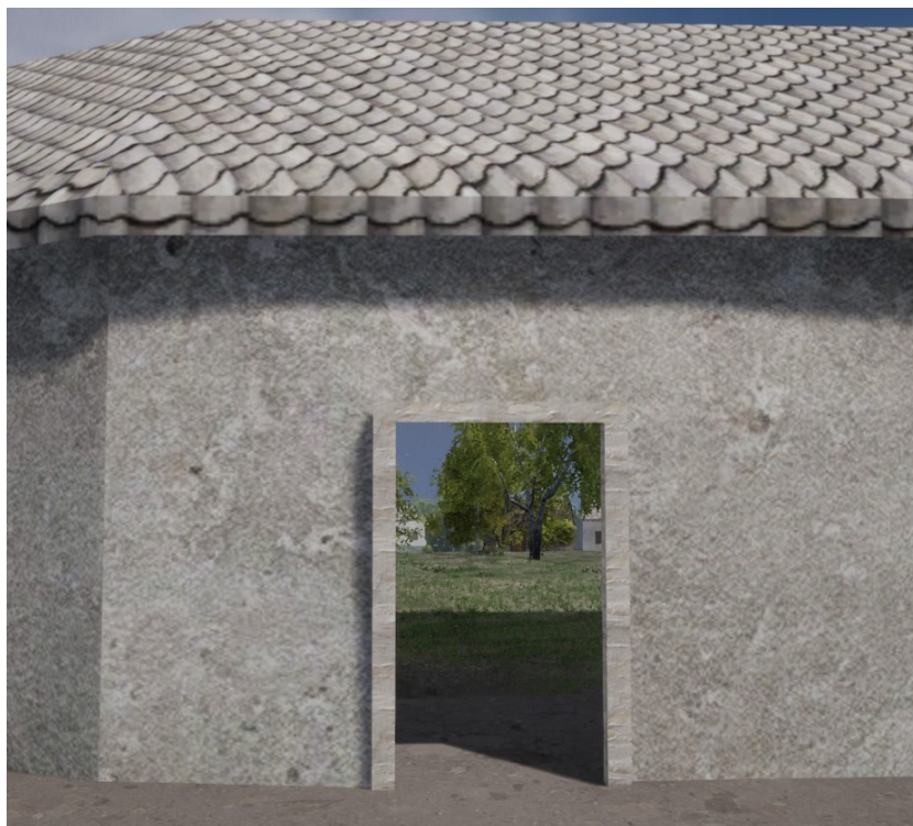
Obrázek 11. Průhledné dveře v důsledku opačně otočených normál
