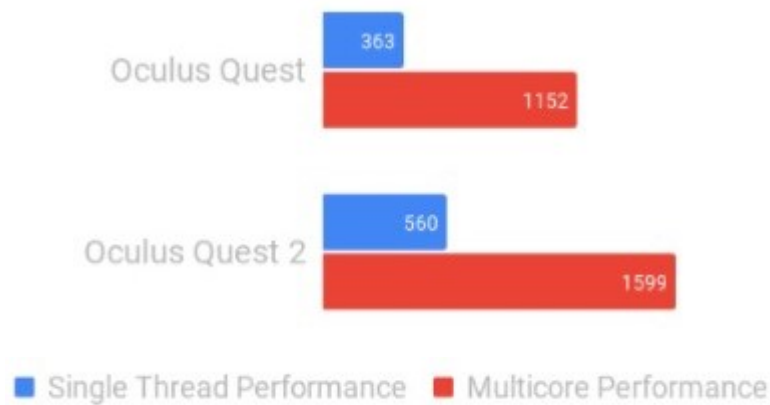
Obrázek 8. Porovnání výkonu procesoru Oculus Quest 1 a Oculus Quest 2 [11]
