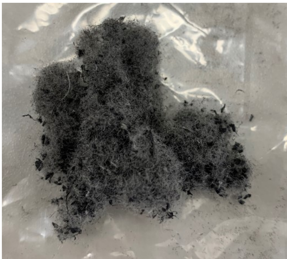
Obrázek 20: Vzorek PES cupaniny odebraný na výstupu drtící linky
