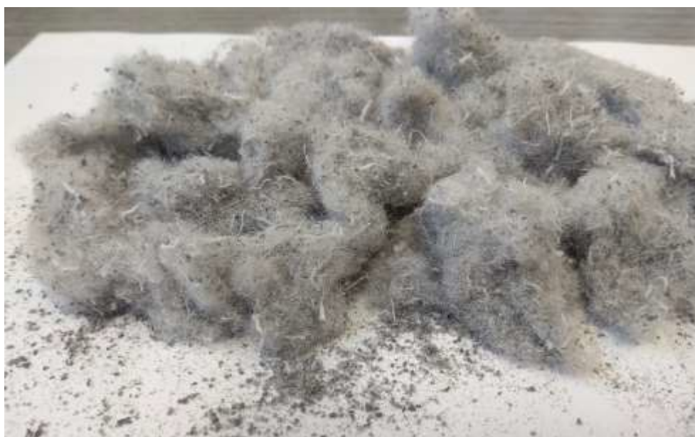
Obrázek 15: Výsledná drť PVC po separaci PES vláken
