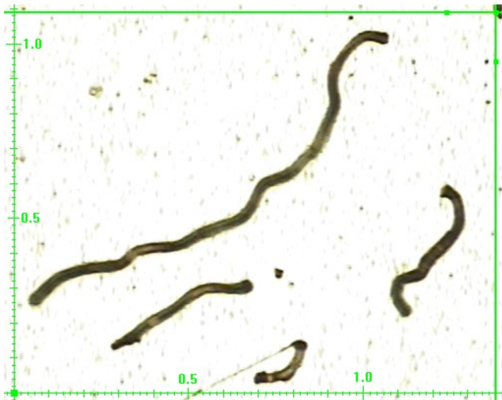
Obrázek 22: Vlákna PES z granulátu cupaniny (zvětšení 120x)
