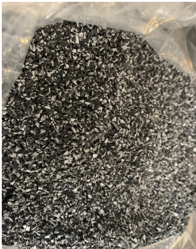
Obrázek 15: Výsledná drť PVC po separaci PES vláken
