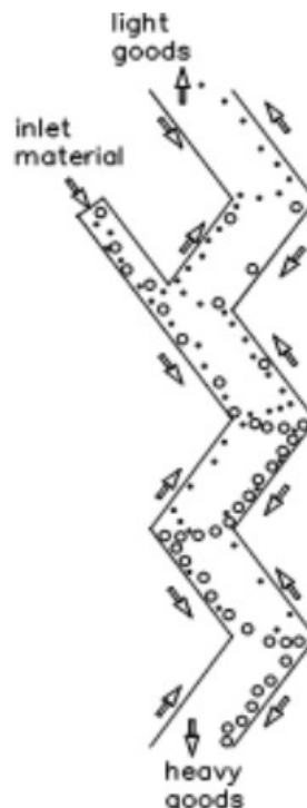
Obrázek 14: Schéma cik-cak separátoru [29]
