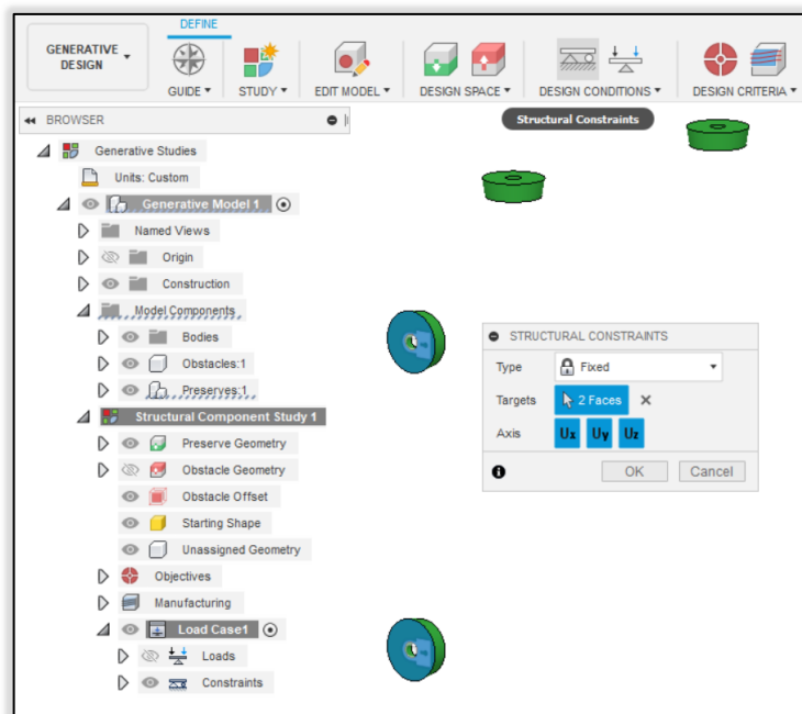
Obr. 87.: Aplikace strukturálních vazeb
