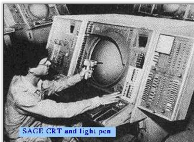
Obr. 1.: Použití světelného pera pro radarový systém SAGE na počítači TX-2 [4]
