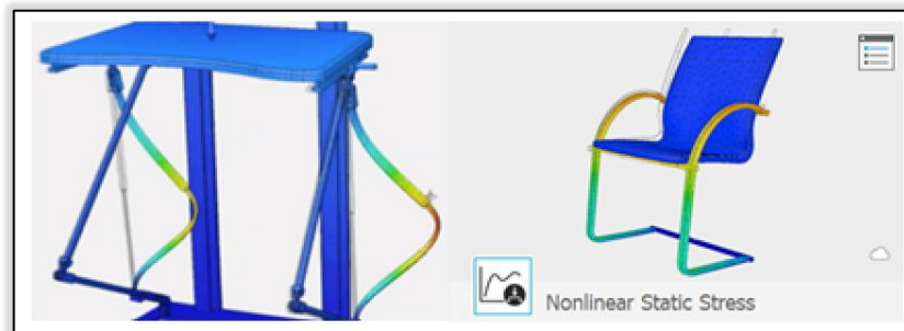
Obr. 21 Pokročilé simulace ve Fusionu360 [3]
