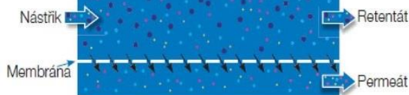
Obrázek 5 Schéma cross-flow filtrace (JIRÁNKOVÁ, a další, 2015)
