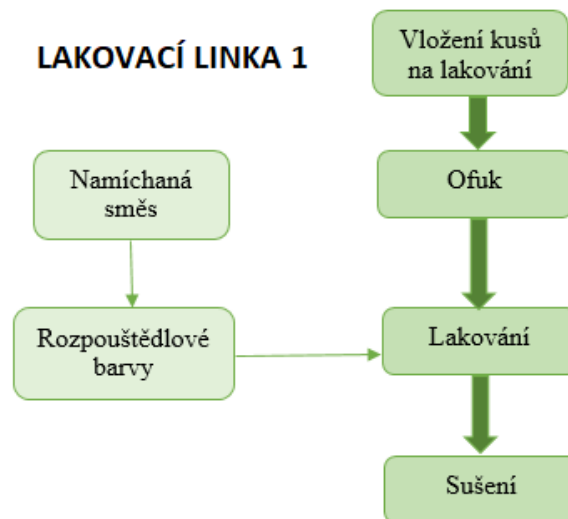
Obrázek 13 Schéma lakovací linky 1 (vlastní zpracování)
