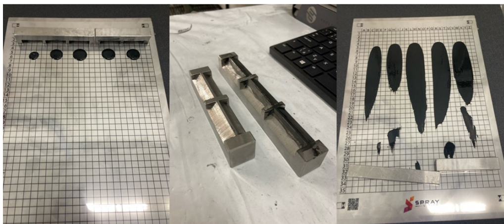
Obrázek 25 Postup nalítí barvy na fólii (interní zdroj)
