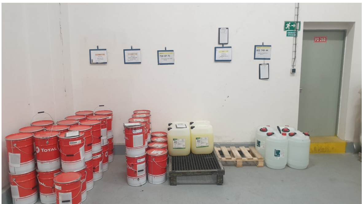
Obrázek 37 Stav po implementaci metody 5S (Vlastní foto)
