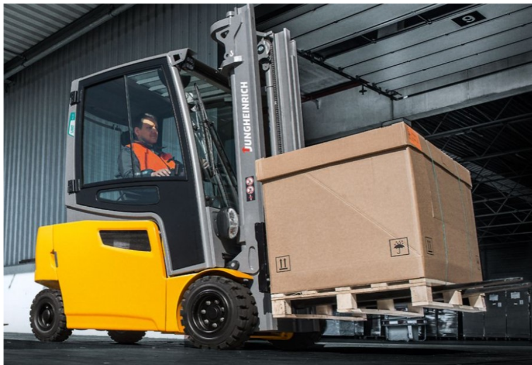
Obrázek 10 Elektrický čelní vozík Jungheinrich (Jungheinrich, 2021)
