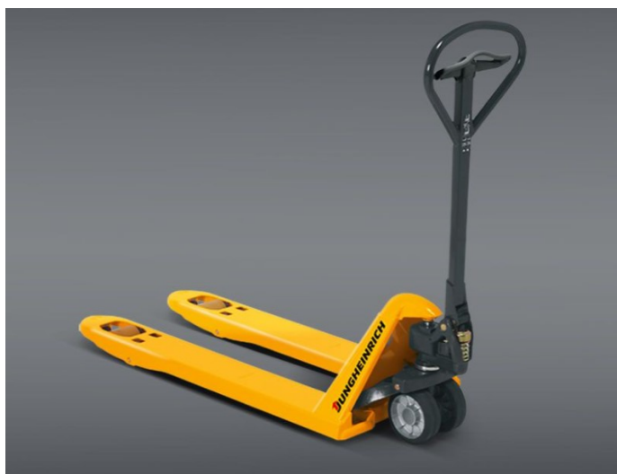
Obrázek 8 Ruční nízkozdvihný paletový vozík (Jungheinrich, 2021).
