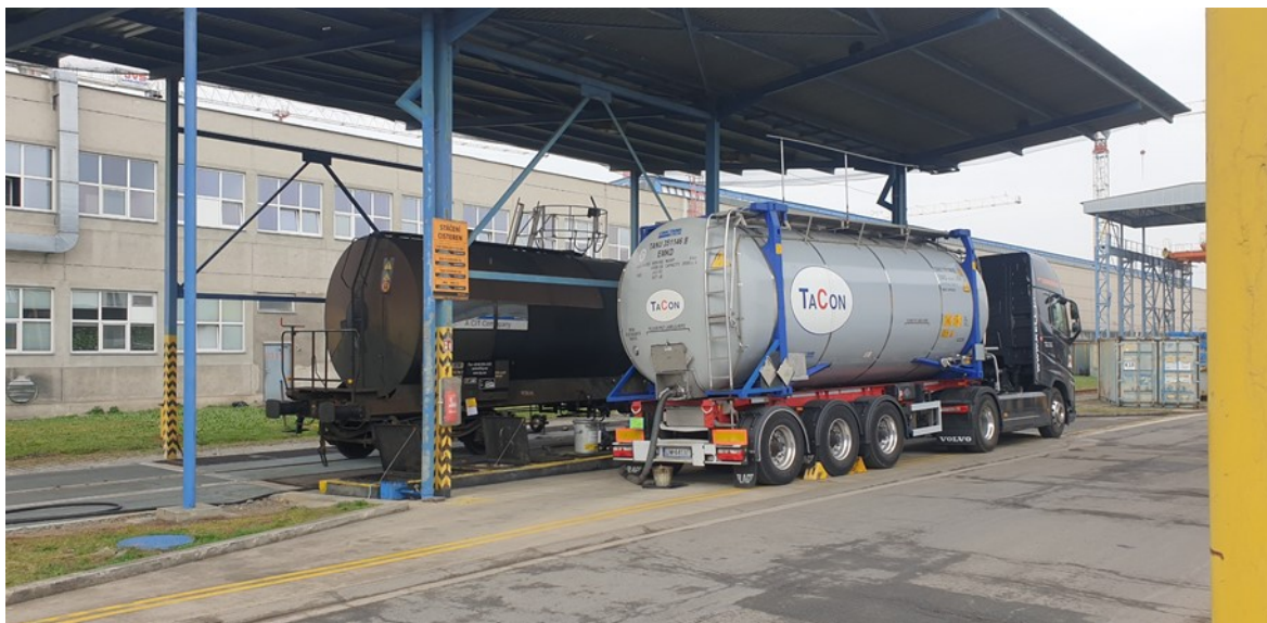
Obrázek 22 Stáčení cisterny se změkčovadlem Tudalen (Vlastní foto)
