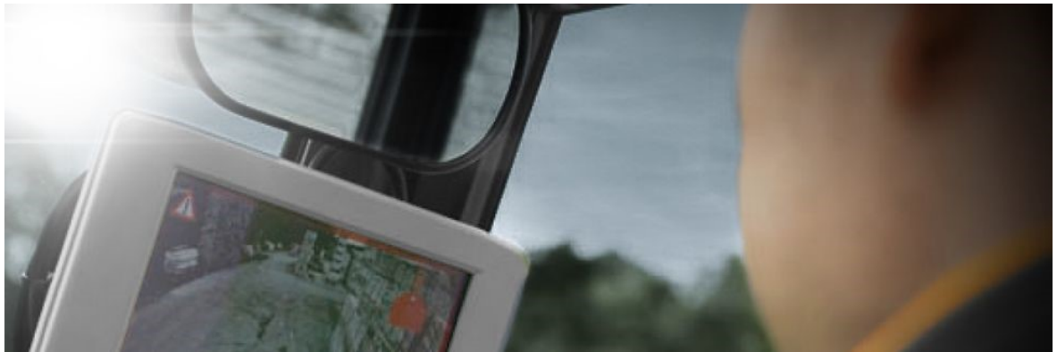
Obrázek 4 Kamera na couvání s funkcí rozpoznání osob od firmy Jungheinrich (Ochrana lidí, 2021)
