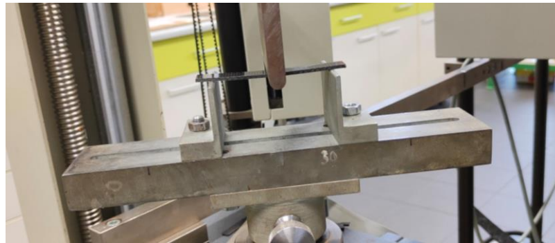
Obrázek 36 Realizace zkoušky tříbodovým ohybem
