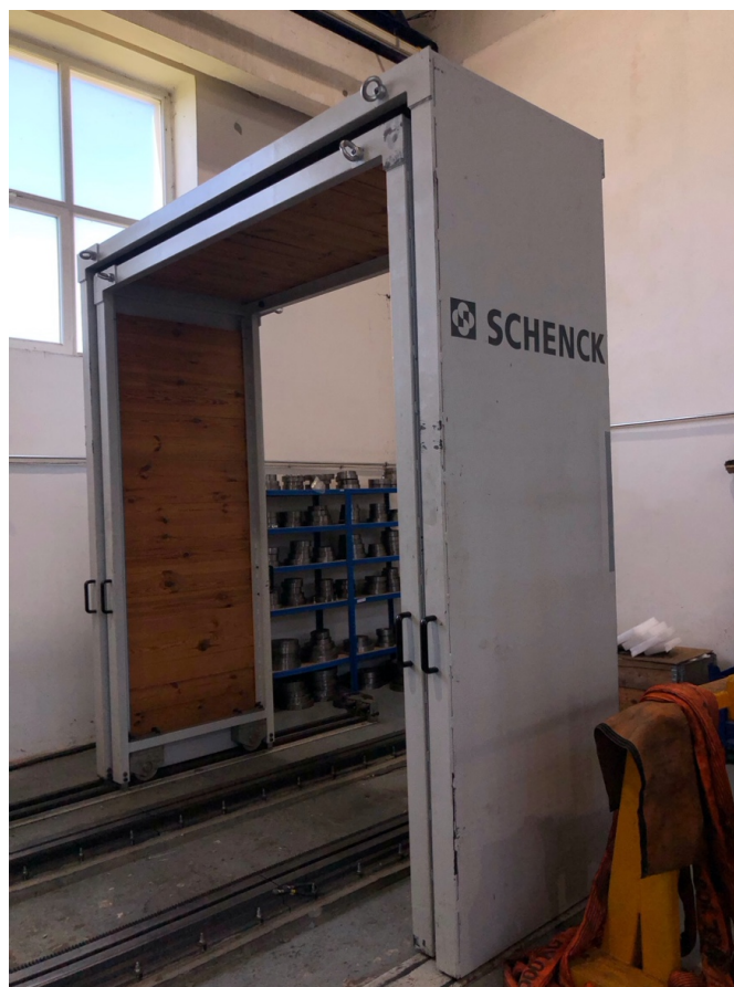
Obrázek 11 Ochranné kryty na kolejnicích (vlastní zpracování)
