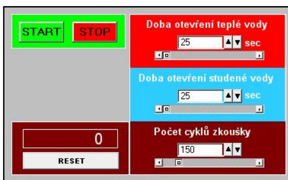
Obr. 23. Nastavení parametrů pro zkoušku vodovodních baterií.
