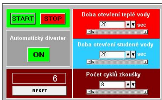
Obr. 27. Nastavení parametrů pro zkoušku diverteru.
