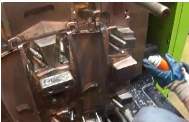
Obrázok 14: Nanášanie spreja na formu (vlastné spracovanie)
