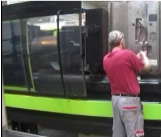
Obrázok 8: Zaistenie formy pred samovoľným otvorením s použitím klasického kľúča (zdroj: vlastné spracovanie)
