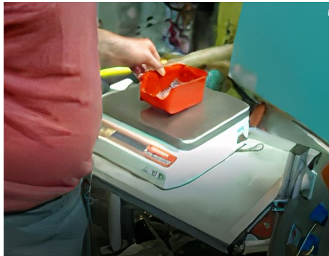
Obrázok 20: Kontrola navážky materiálu do násypky vážením (vlastné spracovanie)
