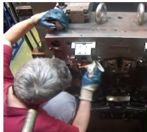
Obrázok 15: Ručné čistenie formy (vlastné spracovanie)
