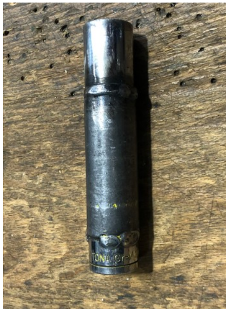
Obrázok 31: Prípravok na rolovanie matíc
