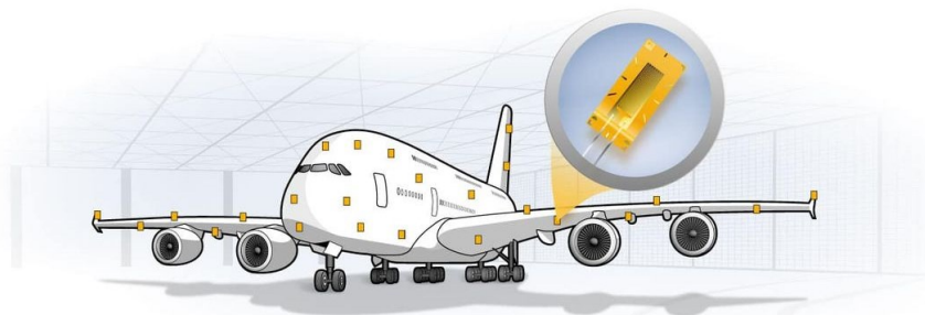
Obrázek 26 Rozmístění tenzometrů na dopravním letadle [23]
