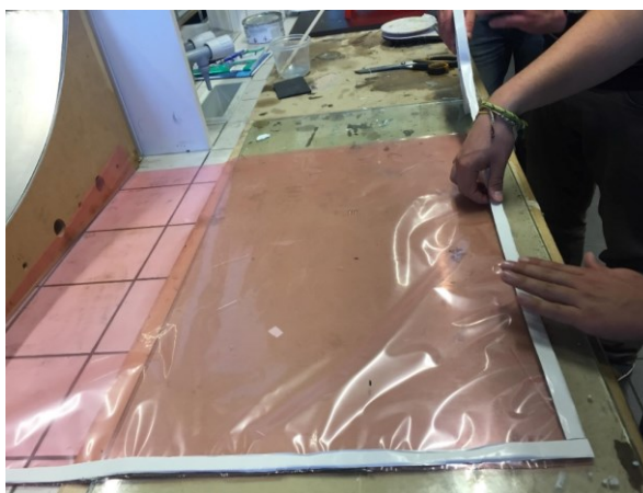
Obrázek 58 Lepení těsnící pásky na vakuovou fólii
