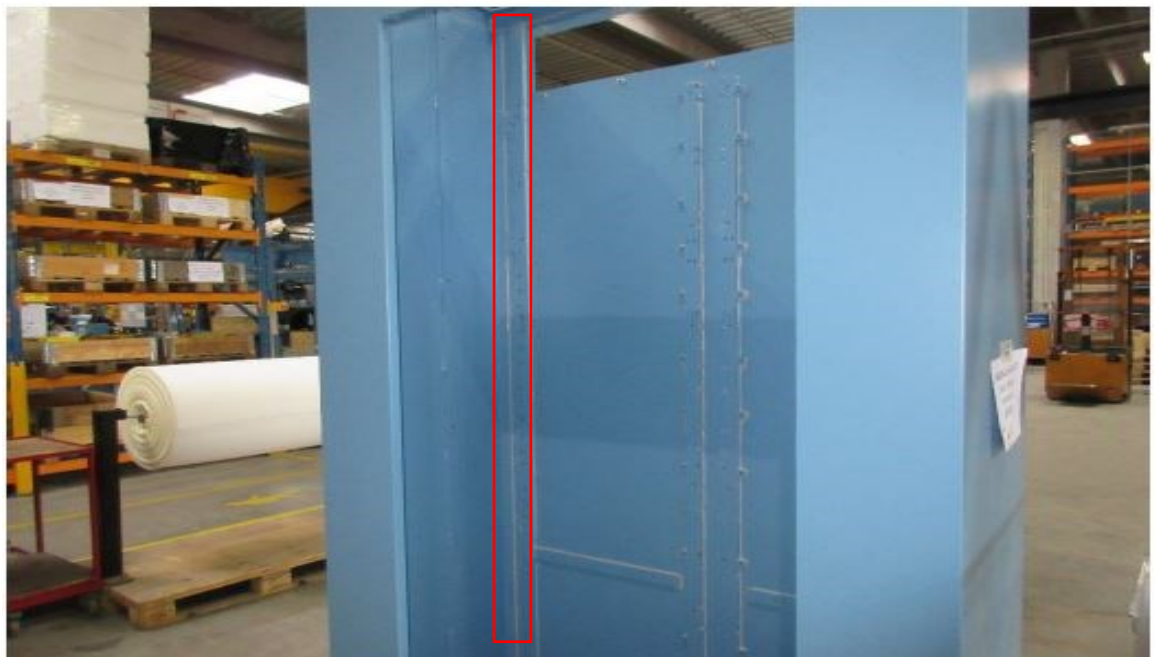
Obrázek 30 osazený montážní panel
