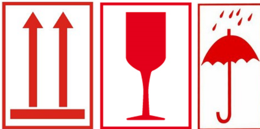
Obrázek 14 Manipulační značky, zleva tímto směrem nahoru (neklopit), opatrně zacházet (křehké), chránit před deštěm [21]
