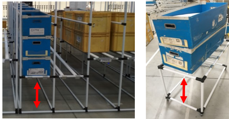
Obr. 23. Ergonomická pomůcka – sjednocená výška skluzky a vozíku (vlastní zpracování)
