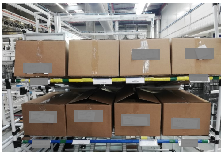
Obr. 58. Nová konstrukce na externí komponenty (vlastní zpracování)
