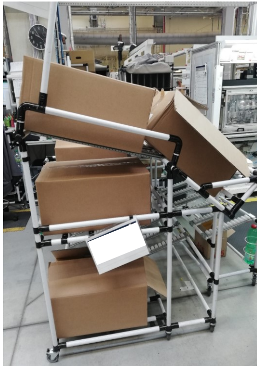
Obr. 57. Nová konstrukce na externí komponenty (vlastní zpracování)
