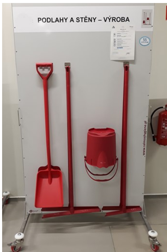
Obrázek 14 Tabule 5S po zavěšení červených čisticích pomůcek (vlastní zpracování)
