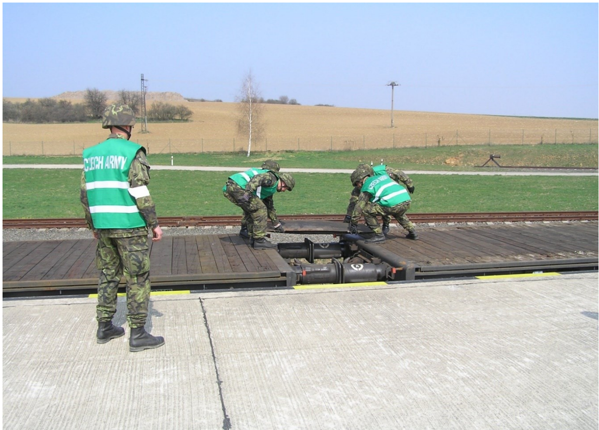
Obr. 16 Přemostění vagónů pomocí ocelových spojovacích můstků
