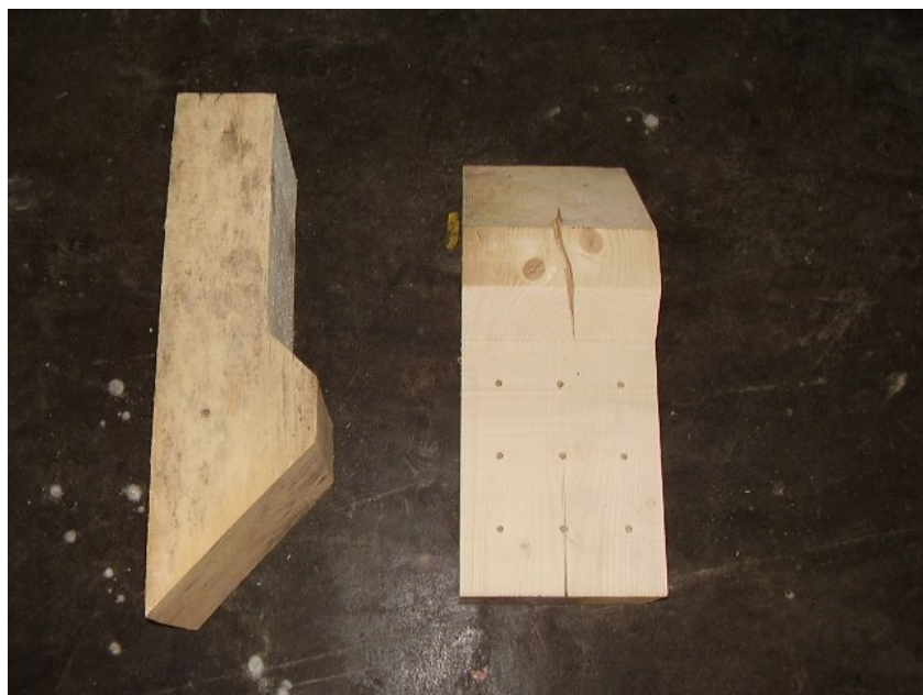
Obr. 22 Dřevěný klín pro podélné ukotvení techniky
