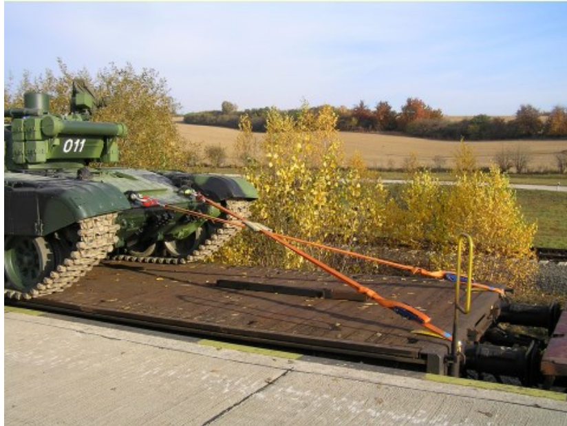
Obr. 27 Ukotvení tanku T-72 upevňovacími popruhy
