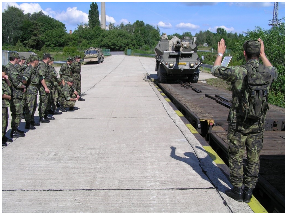
Obr. 29 Navádění techniky na železniční vůz
