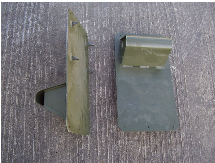
Obr. 19 Klín pro příčné ukotvení techniky
