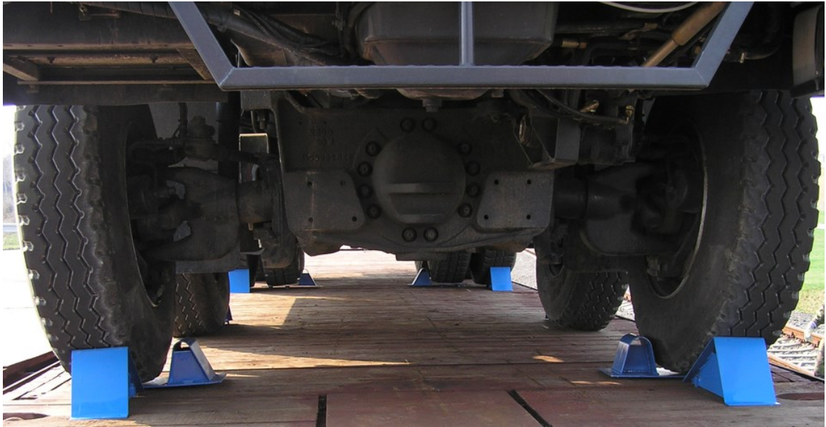
Obr. 21 Ukotvené vozidlo T-815 ocelovými klíny
