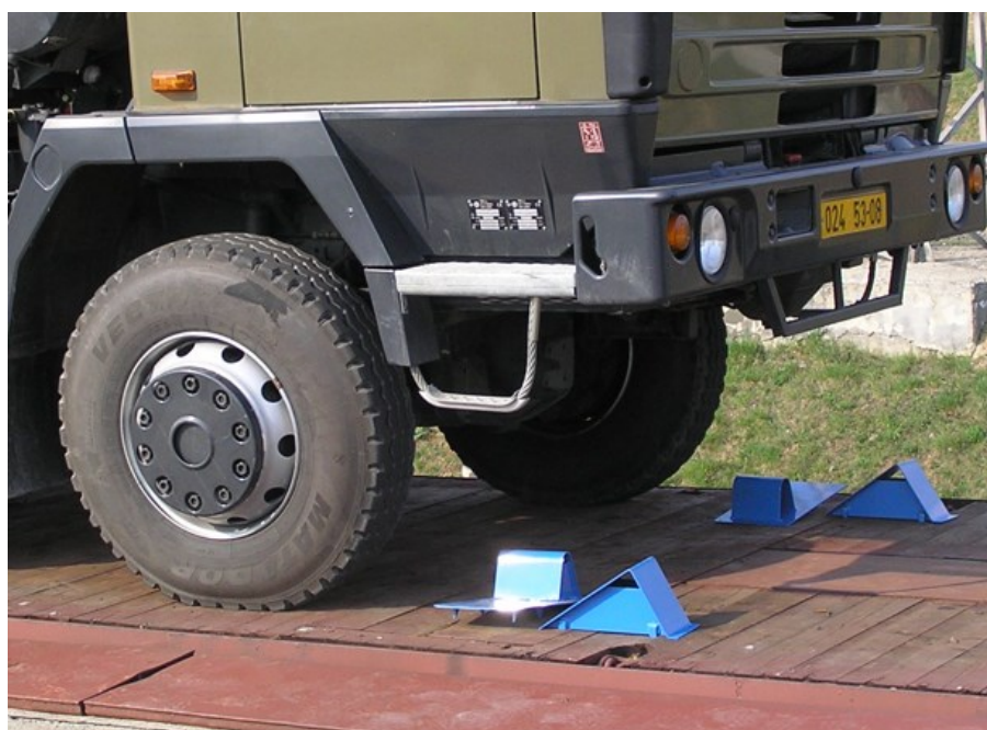
Obr. 20 Vozidlo T-815 na voze před ukotvením
