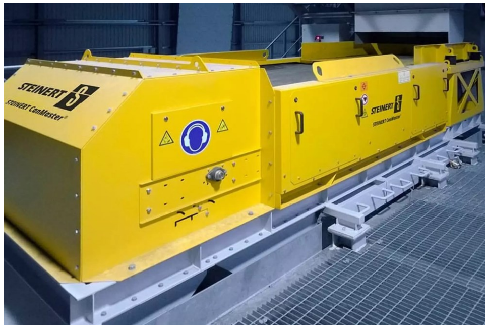
Obrázek 18 STEINERT CanMaster® používaný pro odstranění neželezných kovů z obalových odpadů (70)
