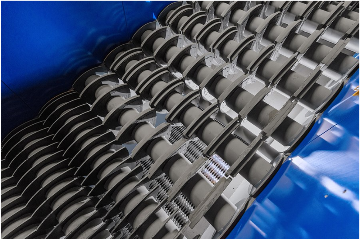
Obrázek 13 Debris Roll Screen® - lze zde vidět do sebe zapadající výstupky z vedlejších hřídelí (56)
