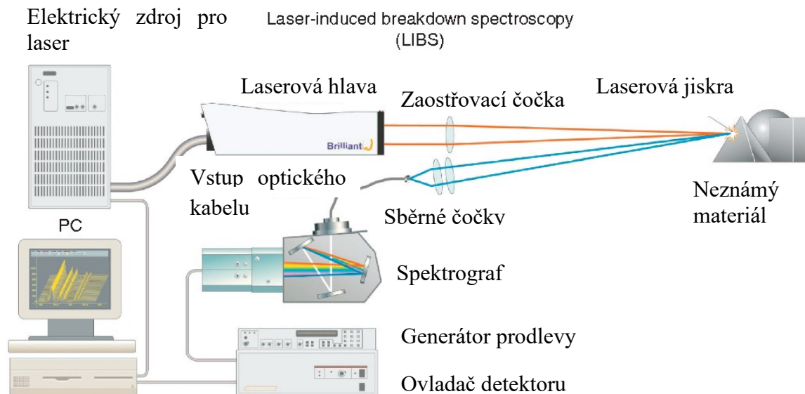
Obrázek 11 Schéma typické laboratorní LIBS sestavy (41)
